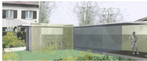
Ein genügend langer Velounterstand mit massiver, dichter Rückwand kann die Aufgabe einer Lärmschutzwand übernehmen.
